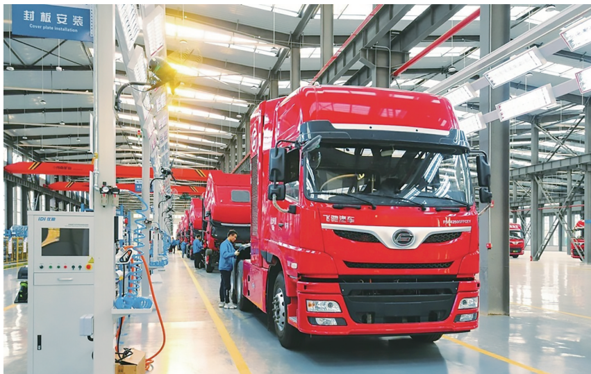
工人正在对氢燃料电池重卡进行装配调试。
