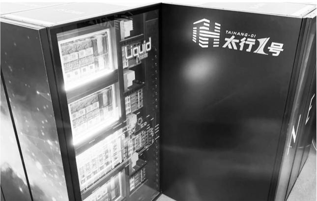
图为8月21日,在国家超级计算太原中心,机组用全浸没液冷技术降温。
